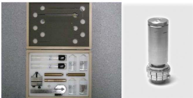
图 37、高压腔选件组件和安装样品后的高压腔
