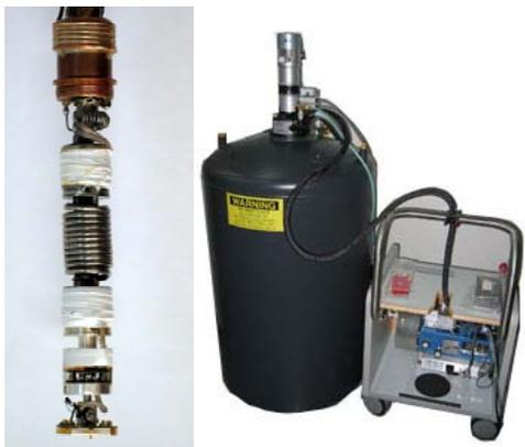
图 31、稀释制冷机前端和安装到 PPMS 上的稀释制冷机
