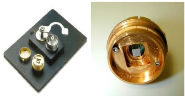
图 27. 比热样品托和专用样品安装工具
