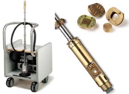
图 30、He3 制冷机小车及测量样品托
