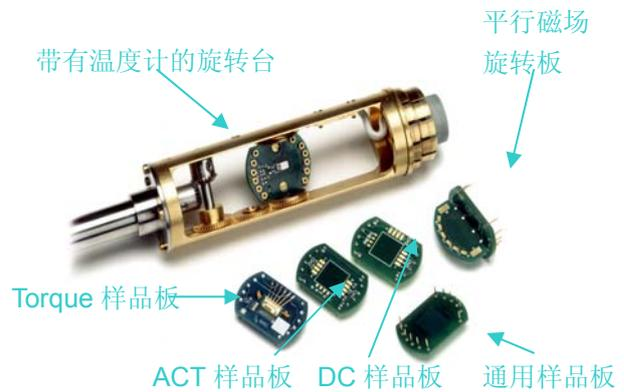
图 23、样品水平旋转杆及各种样品板
