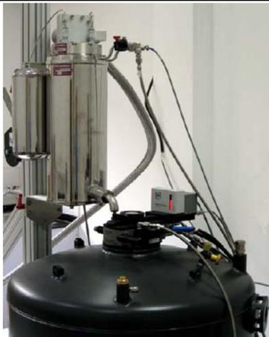
图 36 外挂式液氮自循环系统
