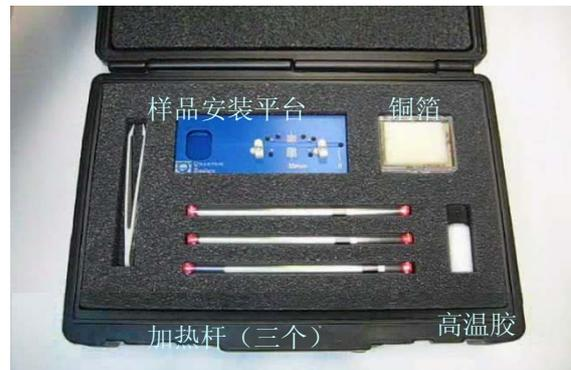
图 16、VSM 高温炉样品安装组件
