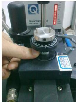
(4) 接上 **Resistivity** 线 (或 **HR** 专用的 **ACT** 线), 然后通过 **Romcfg32.exe** (**C:\QdPpms\Tools**)发送正确的配置文件 (**Resistivity** 的和 **ACT** 的不同)。
