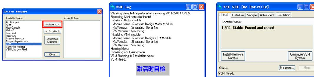
**Install:** Install/Remove Sample-----装样、取样的标准指导步骤 (**装样/取样请严格按提示逐步执行**); **Configure VSM System**-----指定 **VSM** 线圈 (非必需, 除非有多个线圈); **Data File:** 存储数据的位置、文件名; **Sample:** 样品信息 (可以不填); **Advanced:** 数据单位选择。
