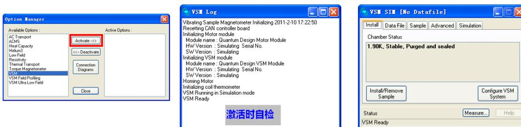
**Install:** Install/Remove Sample---装样、取样的标准指导步骤 (**装样/取样请严格按提示逐步执行**); Configure VSM System----指定 VSM 线圈 (非必需, 除非有多个线圈);
